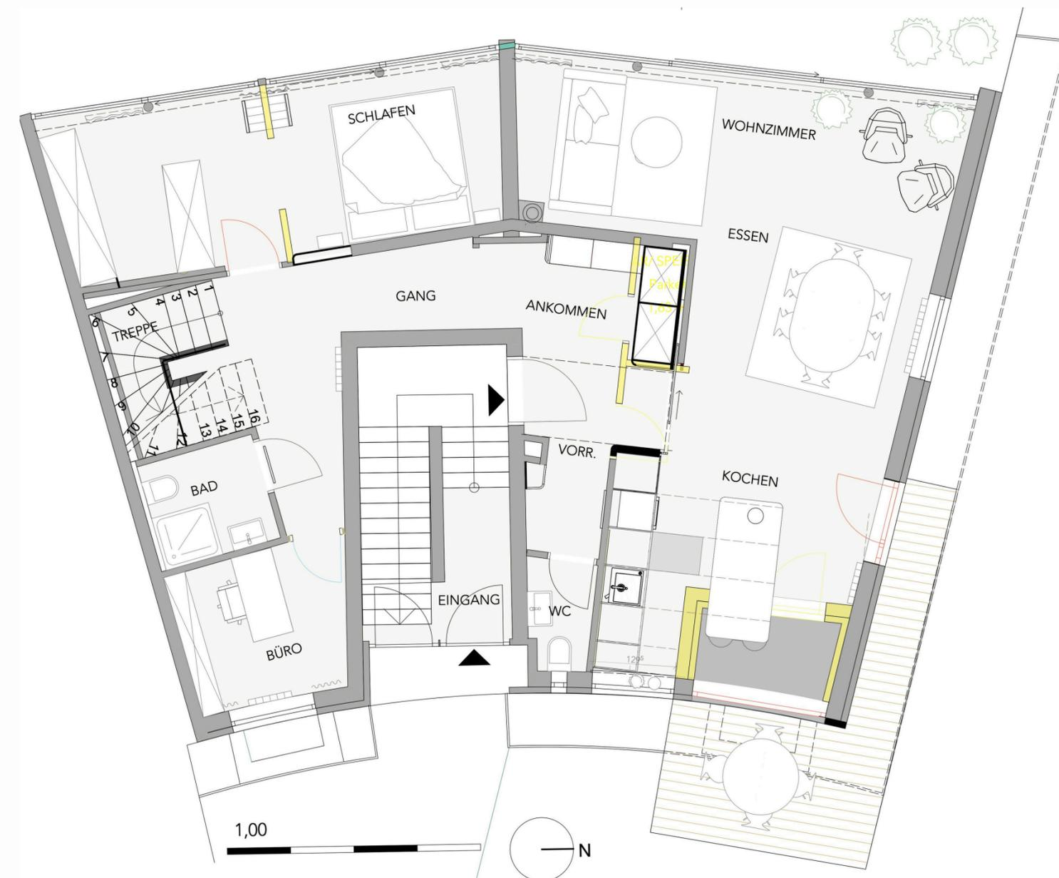
Der ehemals enge Vorraum wird komplett neu gestaltet. Der Garderobenraum sowie die Glasdrehtüre werden abgebrochen und durch einen raumhohen maßgeschneiderten Schrank sowie eine raumhohe etwas breitere Glasschiebetüre - an einer besseren Stelle ersetzt. Die Rundungen schaffen einen weichen Übergang und eine angenehme Willkommen heißende Atmosphäre - als ersten Eindruck im neuen Zu Hause.
